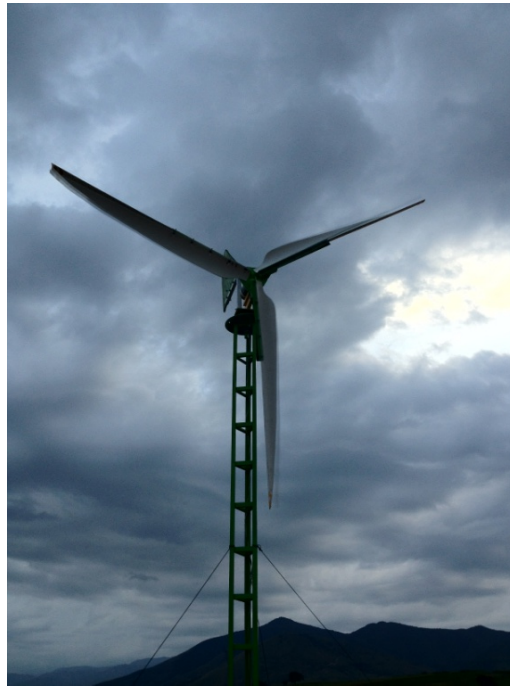
Aerogenerador de baja potencia, palas de fibra de maguey.
