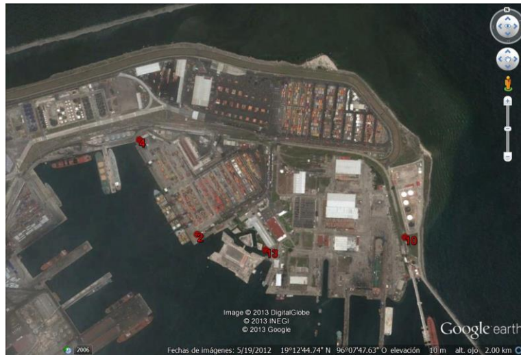
Figura 16. Distribución de puntos de vibración ambiental en el entorno al islote de San Juan de Ulúa
