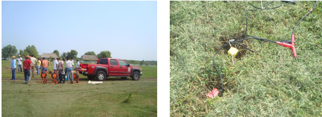
Fig. 6.- Zona de estudio y geófonos para refracción sísmica.
