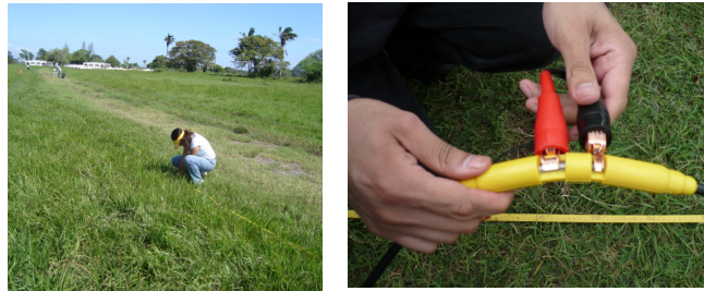
Figura 5.6.- Conexión de geófonos con cable de 12 canales.
