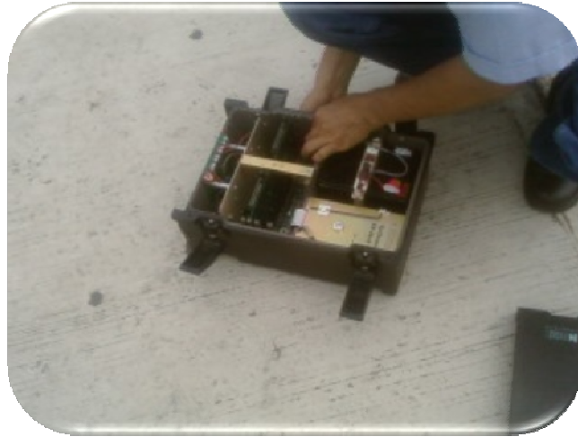
Figura 5.6 Nivelación del ETNA.
